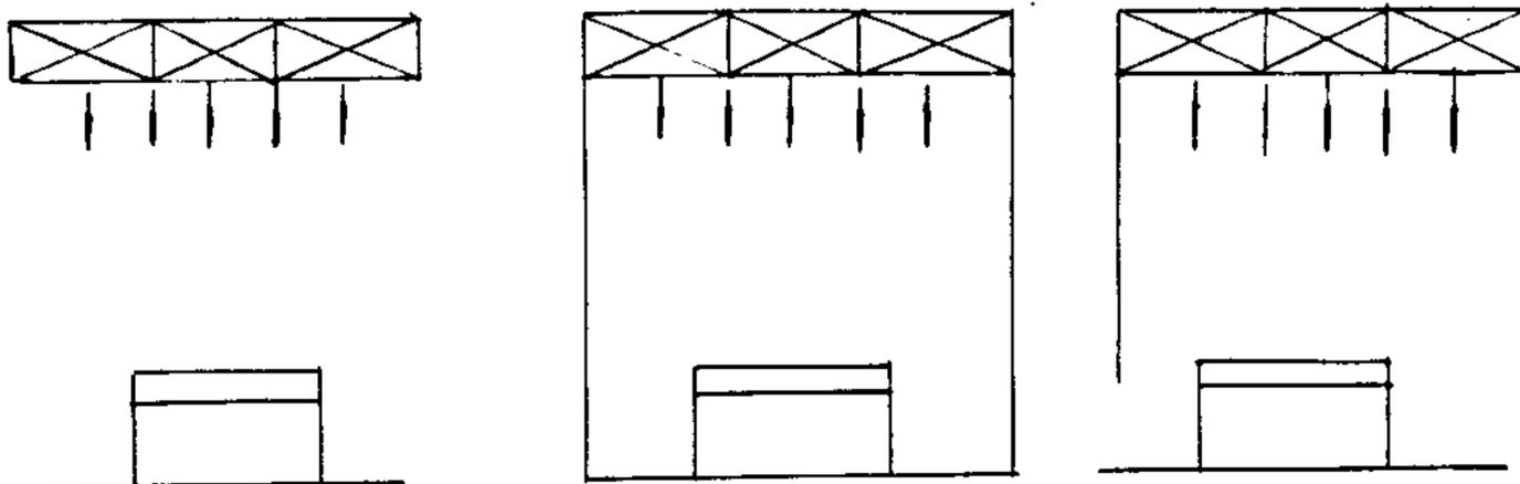
采样点数参见 5.4.1.1, 采样点一般在工作台面上 0.2 m 高度的平面上均匀布置。
